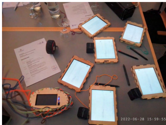
Abb. 11: Avocad0-Lehrerserver und sechs zugehörige Lerner-E-Ink-Tablets, geschützt in speziell lasergeschnittenen Holzgehäusen.
