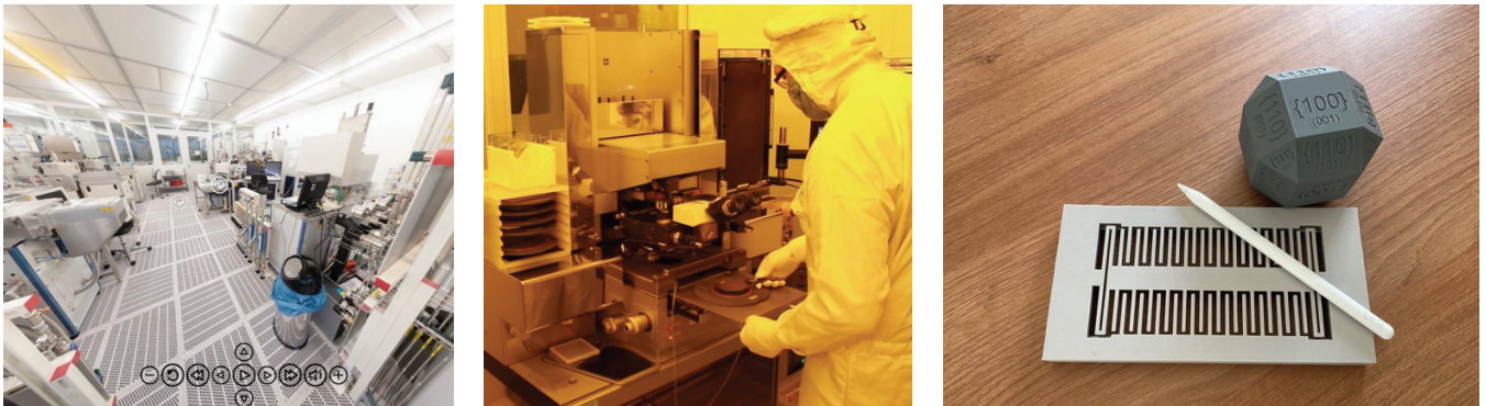
Abb. 2: (links) Bildausschnitt aus der virtuellen Reinraumlabortour; (Mitte) Ausschnitt aus einem Mikrotechnologie-Prozesstechnik-Video: UV-Lithographie; (rechts) Beispiel für ein stark vereinfachtes 3D gedrucktes Modell eines Beschleunigungssensors mit kapazitiver Auslesung und ein Modell zur Visualisierung der Kristallebenen und -richtungen bei einem Silizium-Einkristall.
