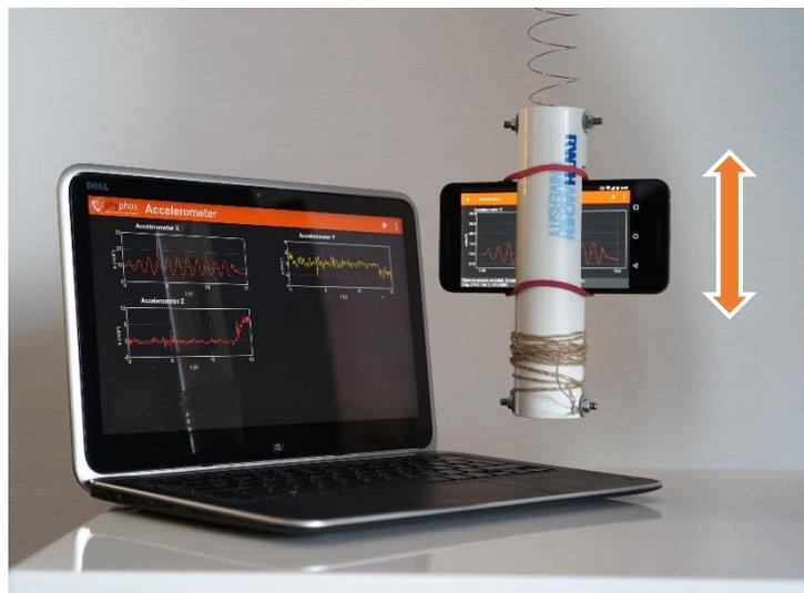
Abbildung 3: Messung eines Federpendels mit *phyphox* (ferngesteuert von einem Notebook). Die hier gezeigte Plastikhalterung soll in einer faltbaren Ausführung aus Pappe ausgegeben werden.
