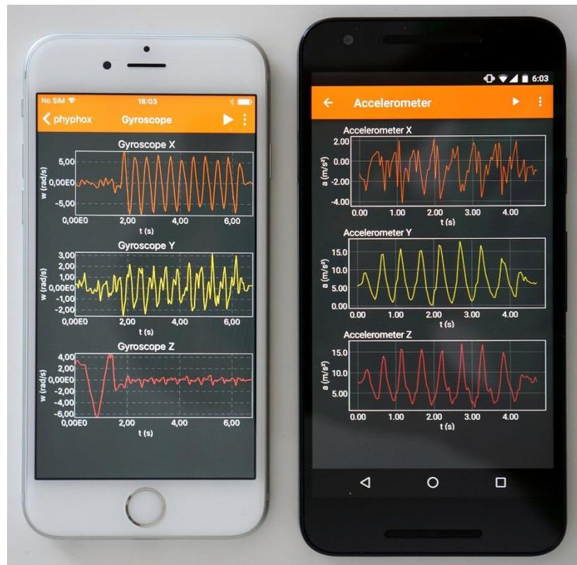
Abbildung 1: *phyphox* auf einem iOS und Android Smartphone. Hier wurden beispielhaft Daten mit dem Gyroskop bzw. dem Beschleunigungssensor in allen drei Raumrichtungen aufgezeichnet. (Die App ist sowohl auf Englisch als auch Deutsch verfügbar.)
